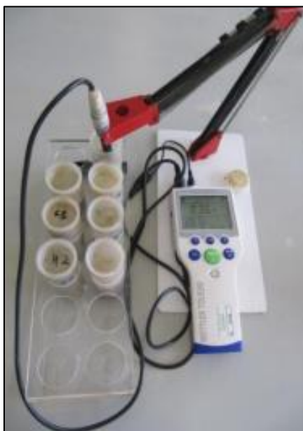
Figura 20. Determinazione pH con pH-metro.
