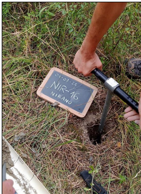
Figura 19. Fase di trivellata della stazione NIR-16.
